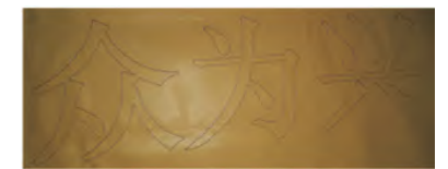
皮料上综合加工-线路、拐角、圆弧
